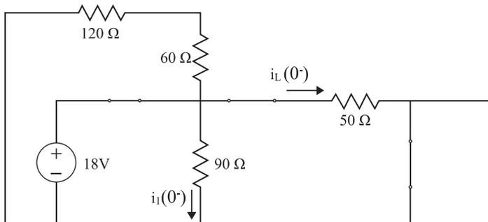
**Figura 1.2.** Condiciones iniciales de  $i_1(0^-)$  e  $i_L(0^-)$
