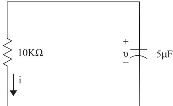
**Figura 1.57.** Circuito equivalente para  $t > 0$
