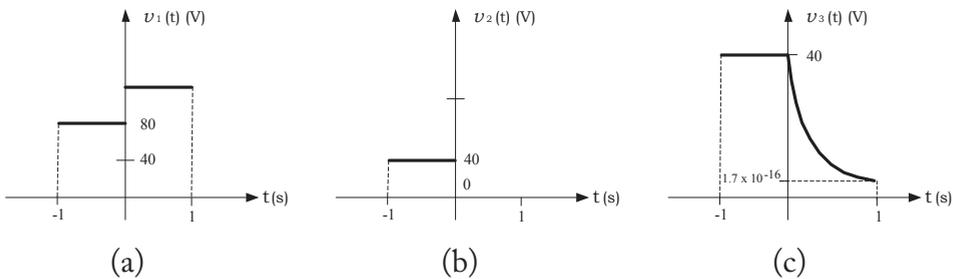
**Figura 1.63** (a) Gráfica de  $v_1(t)$ , contra  $t$ , en  $-1 < t < 1$  seg
