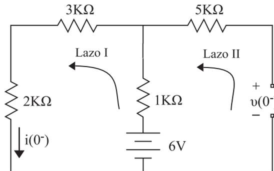
**Figura 1.54.** Condiciones iniciales para  $t < 0$ ,  $i(0^-)$  y  $v(0^-)$
